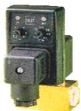
Questo temporizzatore è stato studiato particolarmente per la regolazione delle valvole defangatrici nelle caldaie a vapore e il controllo dello sporcamento dei filtri. E' costruito con la tecnologia SMD E' possibile stabilire la cadenza delle aperture e la loro durata. Di semplice installazione: si applica direttamente tra bobina e connettore.
